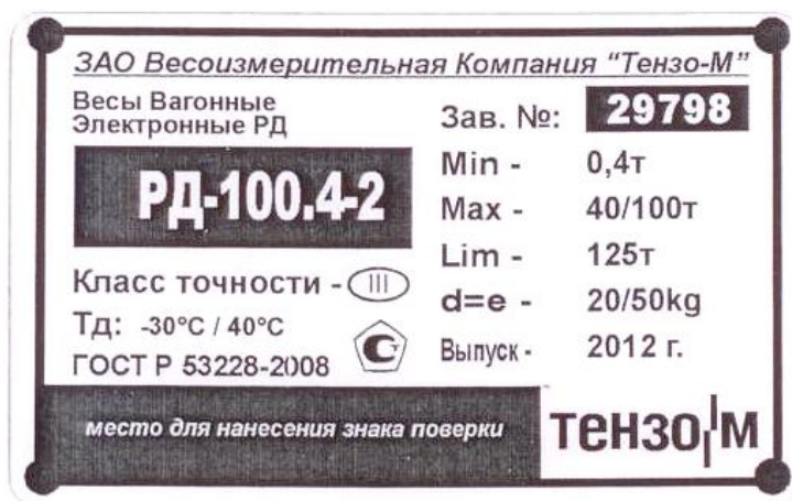
Рисунок 4 – Место нанесения знака поверки в виде наклейки.
